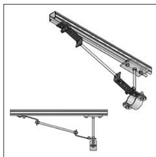
Scharnierstuk met spankracht
